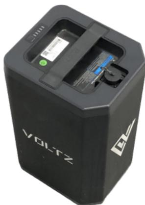
A bateria está localizada na parte dianteira, onde normalmente estaria o tanque de combustível. Para sua remoção, retire a tampa, destrave o manípulo, segure pela alça e empurre a bateria para baixo, liberando-a da trava e puxe para cima. ►► **PG.18**
